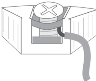
Провод монтируют между пластинами.
